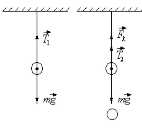
В первом случае на шарик действуют сила тяжести  $mg$  и сила натяжения нити  $T_1$ . Условие равновесия шарика  $mg - T_1 = 0$  или  $T_1 = mg$ .
